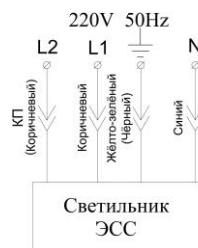
Светильник с аварийным режимом L1- основное питание L2 -контроль присутствия U (подключать от эл. сети 220В фаза)
