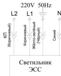
L1- основное питание L2 -контроль присутствия U (подключать от эл. сети 220В фаза)
